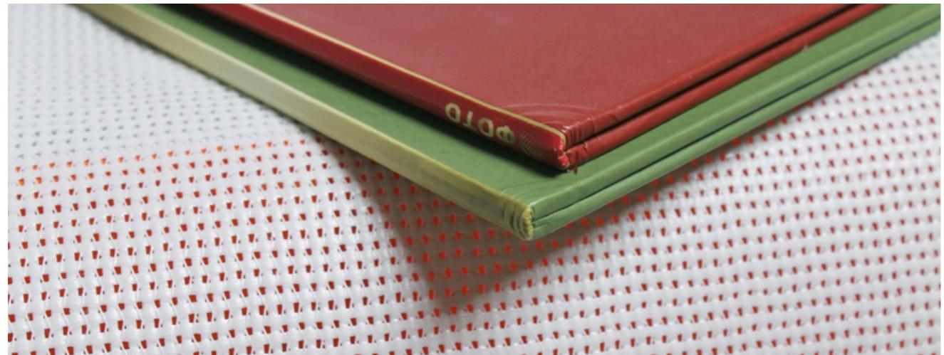
На основе технологии изготовления фотокниг, можно делать планшеты (папки). Папка—фотокнига с одним разворотом (форзацем). Из конструкции обложки убирается отстав и между сторонками делается отступ 8 миллиметров, форзац меньше развернутой обложки на 8 мм по длине и ширине.
